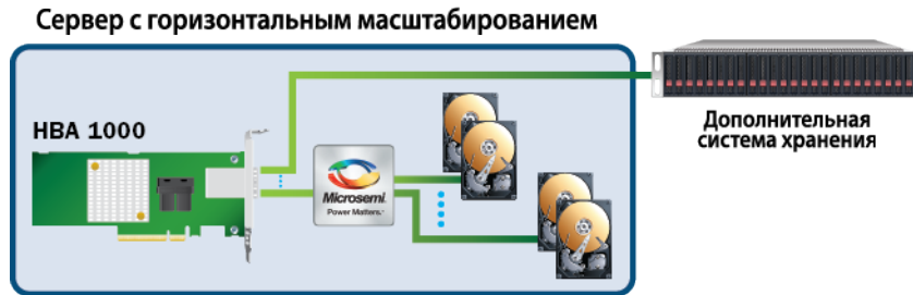
Рис. 4 Расширение последовательным подключением
